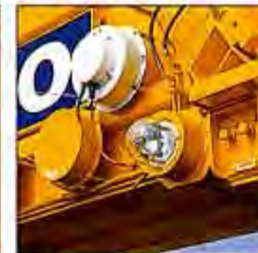
●夜間作業に便利な、リモートコントロール式の明るい作業灯
