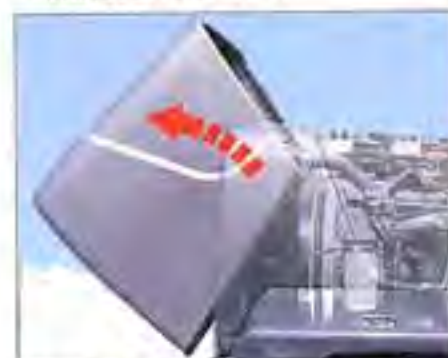
● 保守点検がスムーズ、開閉が簡単なチルト式エンジンカバー
